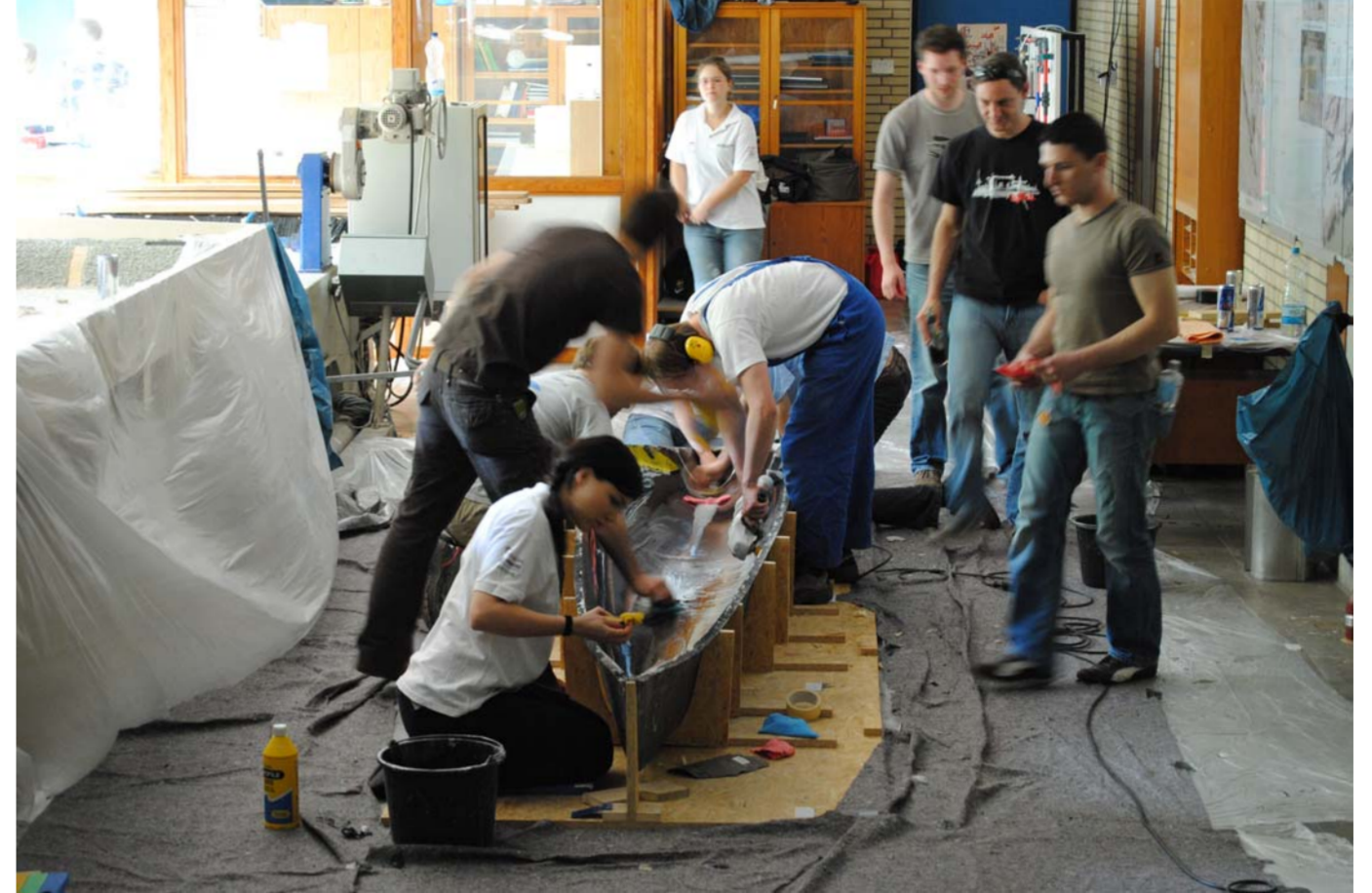
Polieren der Schalung
